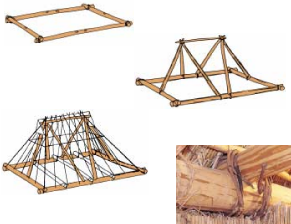
写真12 骨組みの結び
